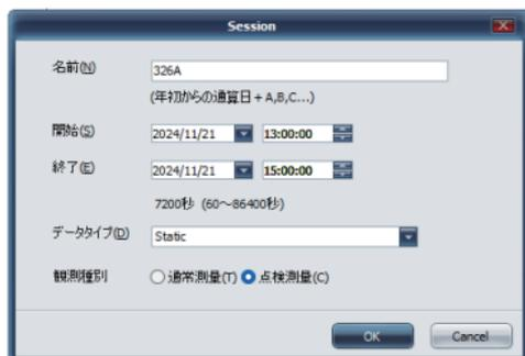
上図のようにセッションダイアログにて、点検測量の指定ができます。ここで点検測量としたセッションは、網平均計算などから除外されます。また、セッションリストのアイコンが黄色の時計アイコンで示されます。
