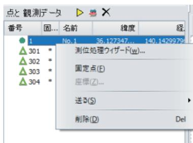
固定点をクリックすると状態が反転します。また、固定点列に \* マークが表示されます。電子基準点との解析を行うと、電子基準点は自動で固定点とマークされます。
