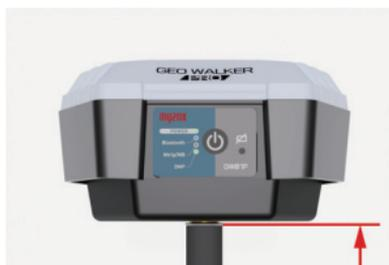
点番号は慣例として1から始めます。必要あればシリアル番号なども入力します。アンテナ基準面は同じアンテナでも複数用意しています。アンテナを選択すると図が出ますので図を見て選択してください。赤線の位置が基準面で地面から赤線までの高さがアンテナ座面高です。
