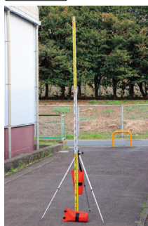
オフセット金具 壁面の基準位置と測定面の位置 関係を合わせる事が可能です。
