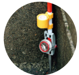
壁面測定時、測距値に4.5mmを加算。
